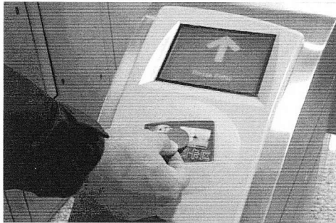
Auf einem berührungslosen Scanner am Eingang wird die Zugangsberechtigung geprüft
